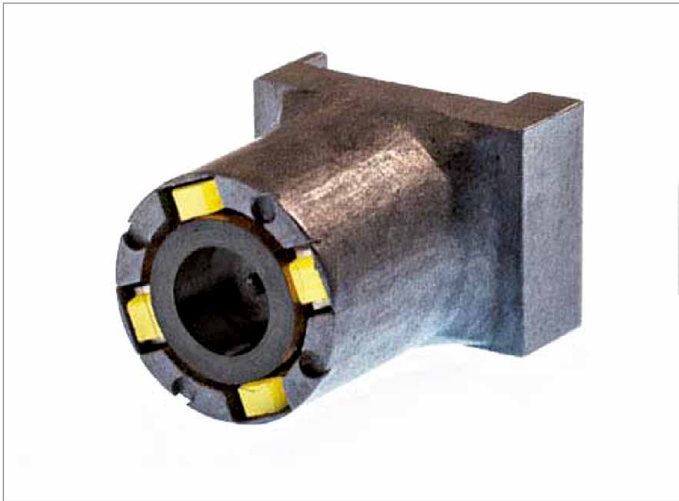
Abbildung 7: Konfigurierbare, modulare Mikrokamera; Größe: 7 x 9 x 12 mm 3 (© innBW)
