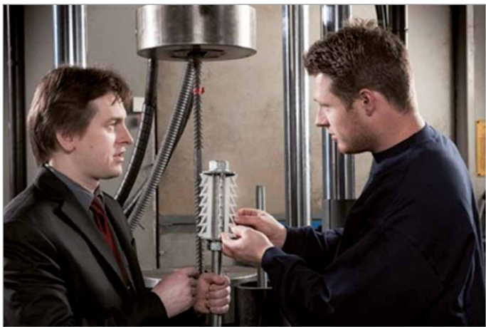
Abbildung 2: Test eines neuartigen Verankerungssystems der Firma CVT Industriebedarf am Karlsruher Institut für Technologie (© Markus Breig, KIT)
